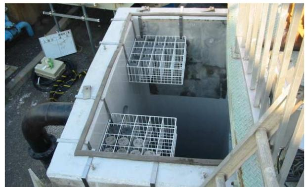
図5 劣化速度測定箇所および暴露試験
