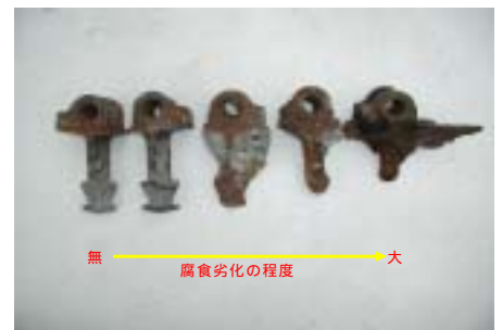
図3 バンドロールショルダーの腐食状態
