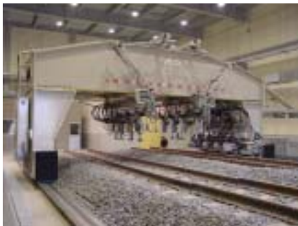
写真 1 実物大軌道試験装置
