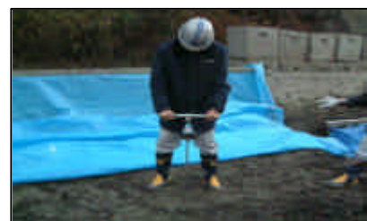
写真4. 現地コーン貫入
