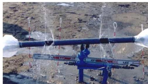
写真-3 注入外管の多段注入入口からの同時吐出状況
