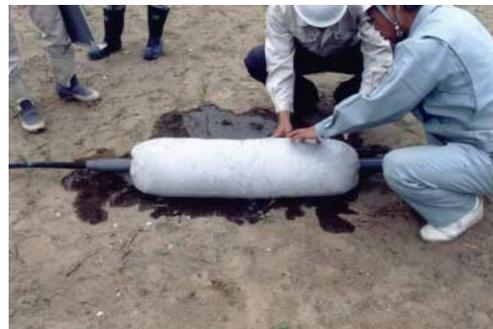
写真-1 袋バッグの充填試験状況
