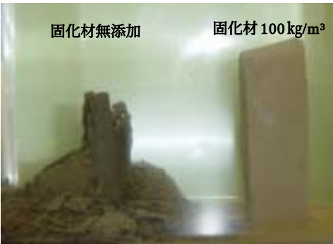
写真－1 水浸時の状況
