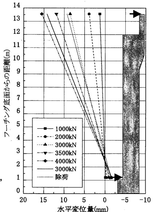
図 2 橋台躯体の水平変位分布
