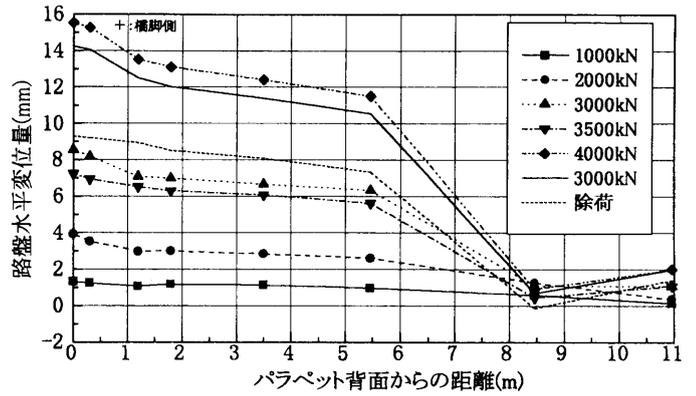
図3 路盤表面水平変位の各荷重段階ごとの分布
