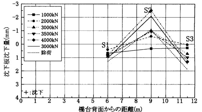
図5 沈下板による沈下量分布
