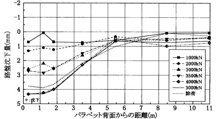
図4 路盤表面鉛直変位の各荷重段階ごとの分布
