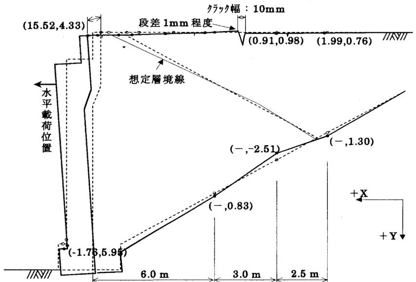
図6 最大荷重時の変形モード
