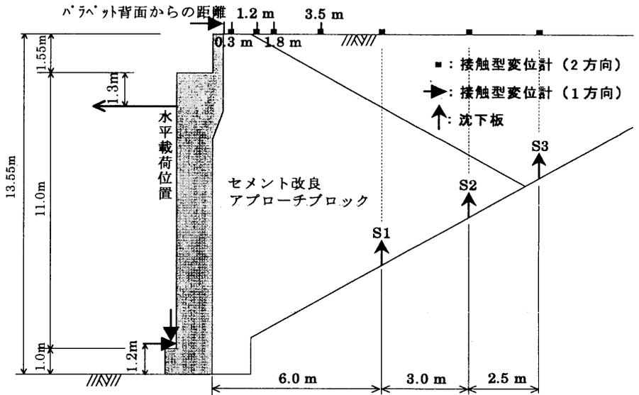
図 1 変位計設置位置の概略
