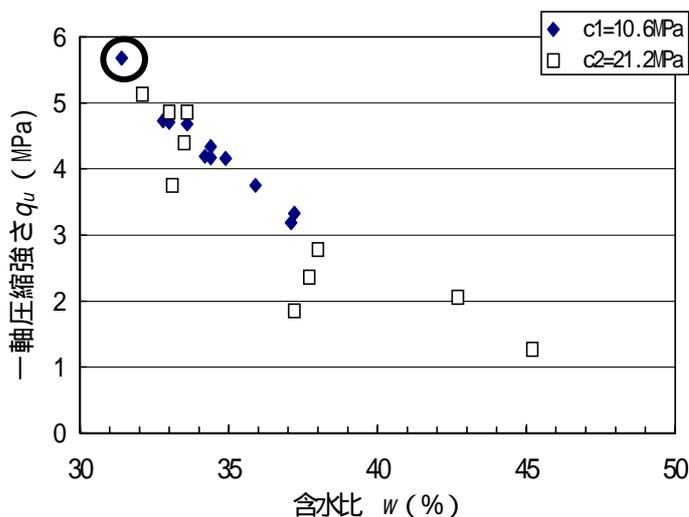
図2 一軸圧縮強さ  $q_u$  と含水比  $w$  の関係
