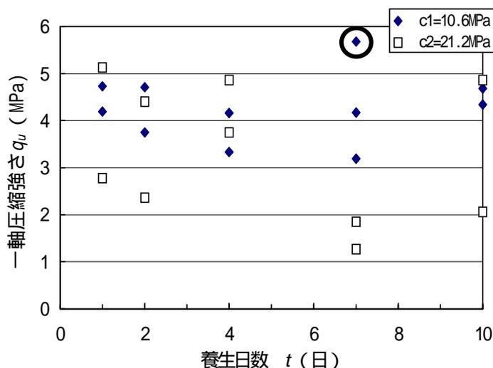
図 1 一軸圧縮強さ  $q_u$  と養生日数  $t$  の関係
