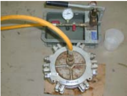
図2. 透水試験状況
