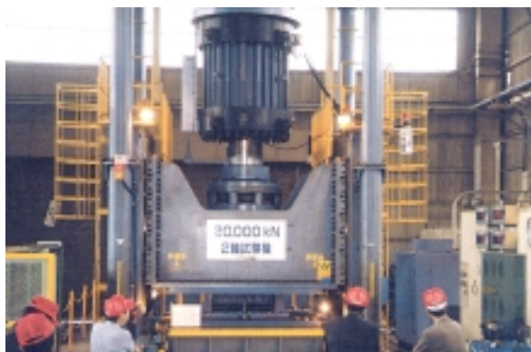
写真—1 20,000kN 圧縮試験機
