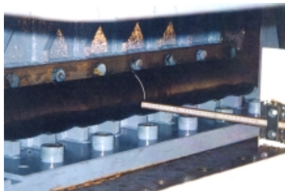
写真—2 圧縮荷重 18,000kN/m、せん断 20mm 載荷時
