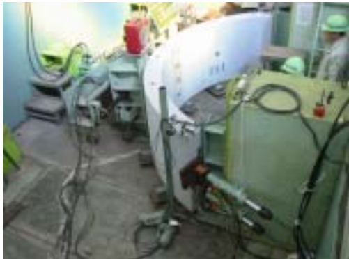
写真-1 軸力導入継手曲げ試験状況
