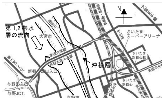
図-2 第1.2帯水層の流向および軟弱層の分布
