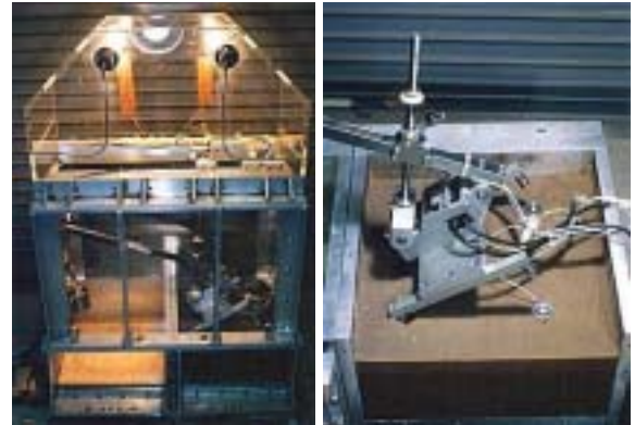
写真-1 実験容器に搭載されたクレーン模型(左)とアウトリガが地盤に沈下して転倒した模型の様子(右)
