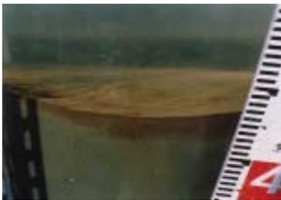
Fig.1 浮泥・堆積泥の採取状況
