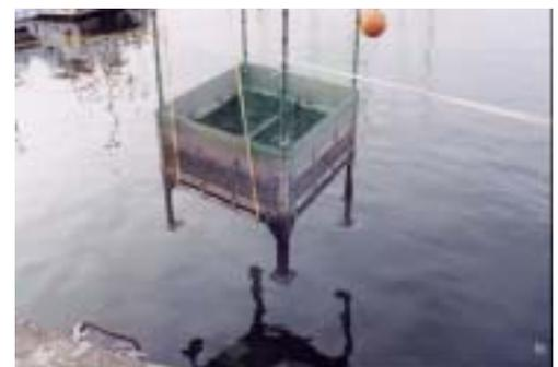
写真-1 人工藻場供試体の設置
