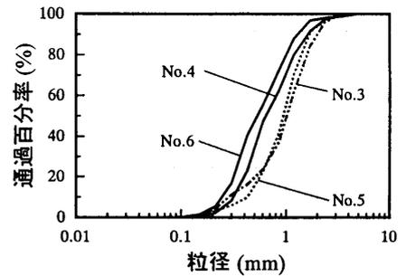
図5 河床材料の採砂地点と粒度分布
