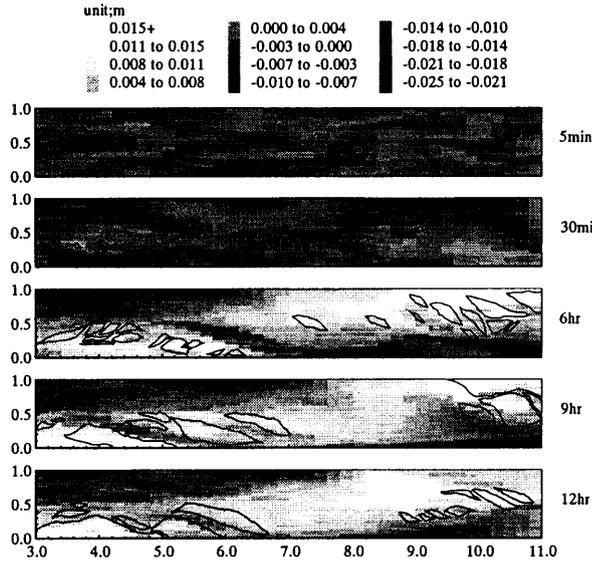
図3 河床形態の時間変化 (混合砂)
