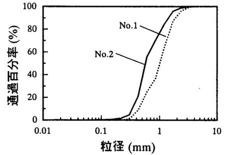
図4 河床材料の採砂地点と粒度分布
