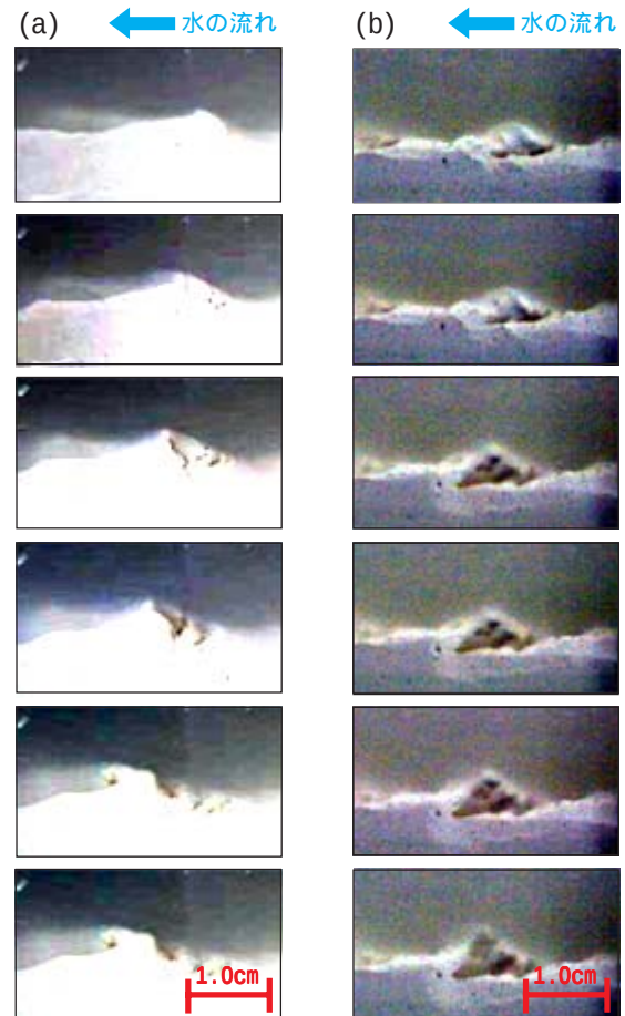
図-2 浸食を受ける供試体： (a) 波の頭が浸食される様子，(b) 塊状に剥離していく様子
