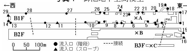
図2 御池地下空間の流入口
