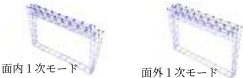
図10. 実験供試体の固有振動解析結果
