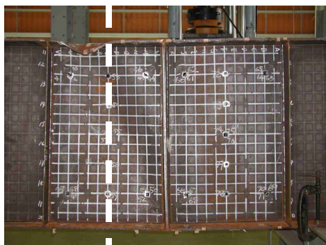
写真2 破壊状況（A-S 2）
