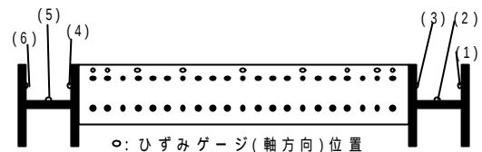
図2．ひずみゲージ取付位置概要
