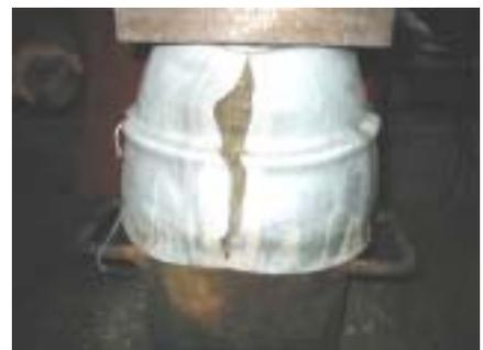
写真-2 充填供試体の破壊状況
