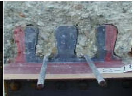
写真-2.終局状況(切断後)
