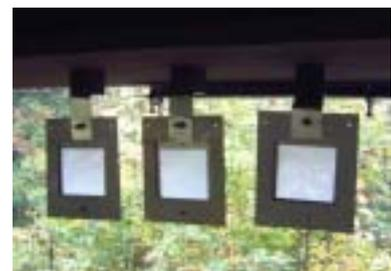
写真 3 飛来塩分捕集器
