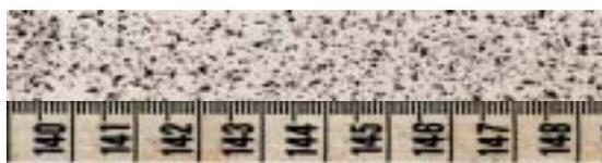
写真-1 セロテープ試験結果の一例
