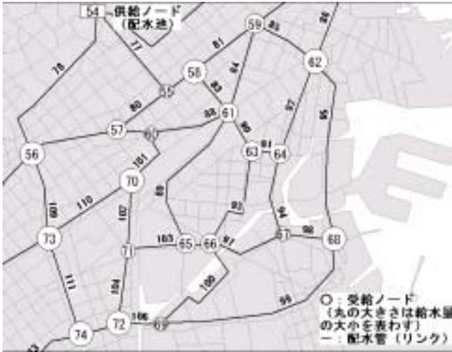
図 - 1 解析対象の上水道ネットワークの例
