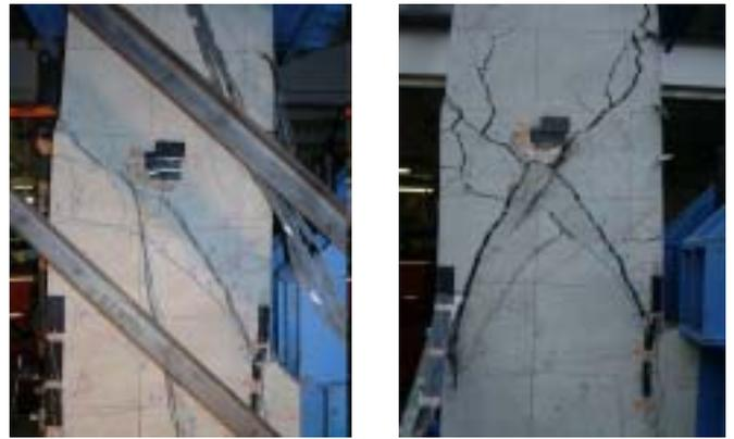
(1)正側最大荷重時 (2)負側荷重抜け時
