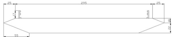
図2 実験模型断面諸元（単位：mm）
