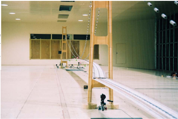
写真 2 試験状況（風洞風速 8.4m/s）
