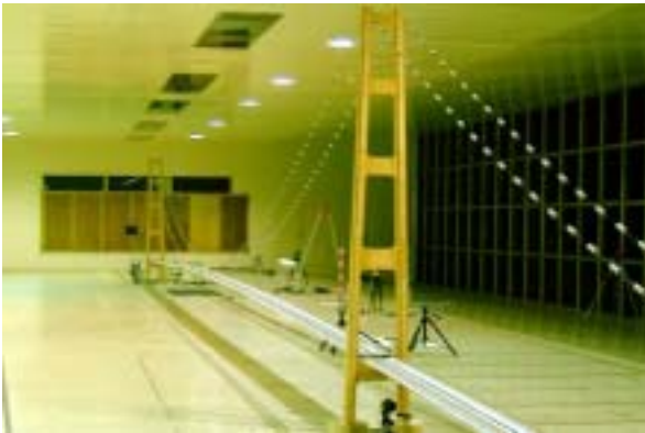
図—6 大型全橋模型の完成状況
