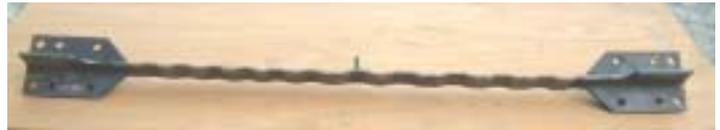
写真-1 ブレースの変形状態 (BR59-12)
