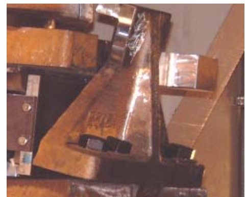
写真-3.2 ピボットローラー支承橋軸直角方向試験後状況
