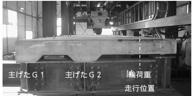
写真-1 試験装置および試験体
