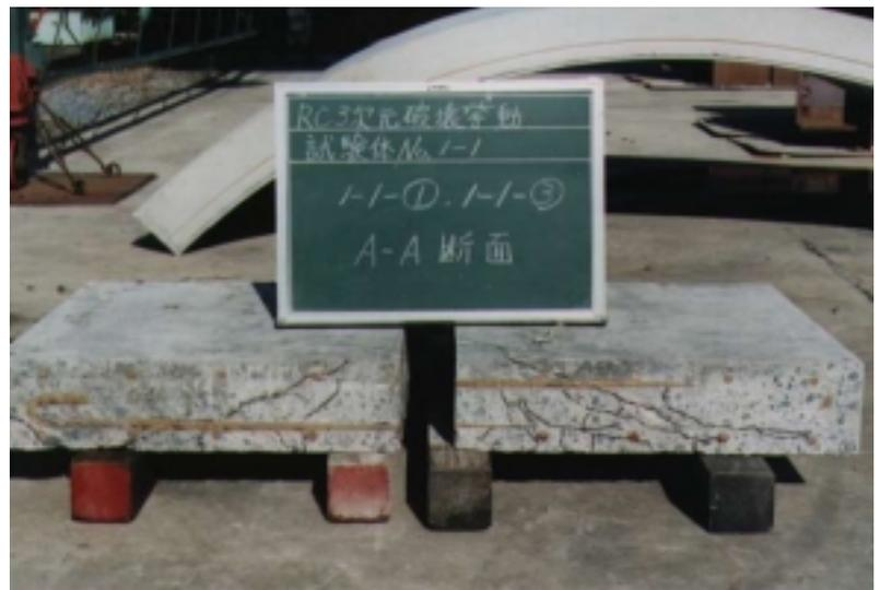
図4 押し抜きせん断破壊面写真
