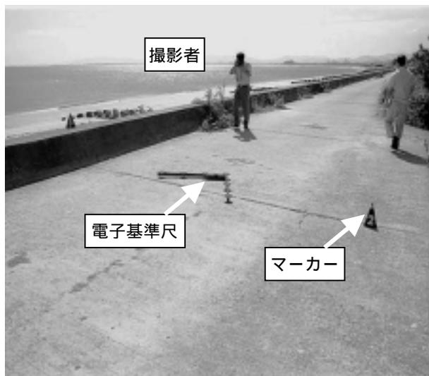
図-1 写真測量現地作業風景
