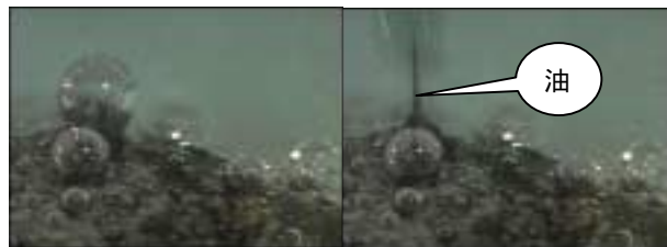
写真 - 1 油の剥離・連行状況
