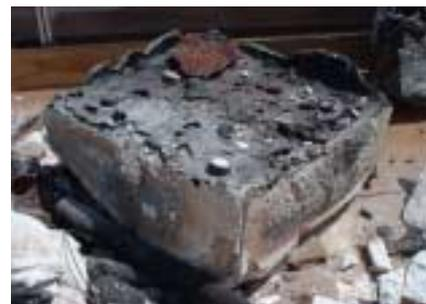
図-4 溶融固化後の固化体
