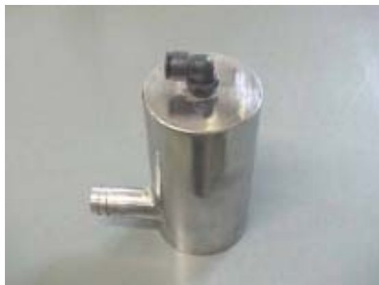
図-2 M2-L型MB発生装置
