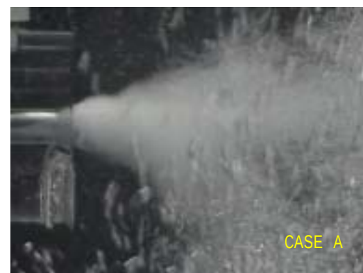
図-6 噴出口の様子（ Q_a=2.6 l/min）
