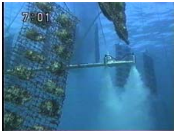
図-3 マイクロバブル噴出状況（NHK放送画像より）
