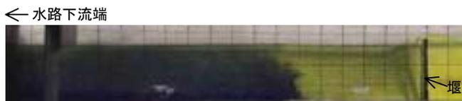
写真-1 塩水と淡水の混合状態
