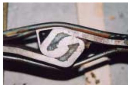
写真-1 水浸漬後の継手の状況
