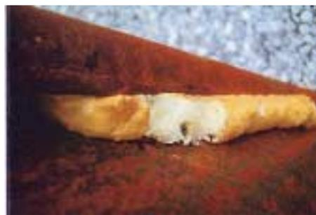
写真-2 発泡ウレタンフォームで保護した継手の状況(硬化後)
