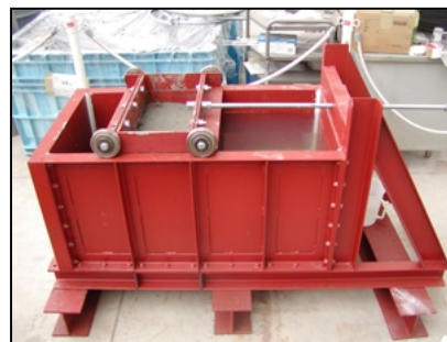
図3 変形追随性確認実験土槽
