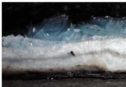
写真 - 4 不織布での薬液の固結状況
