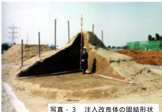
写真 - 3 注入改良体の固結形状
