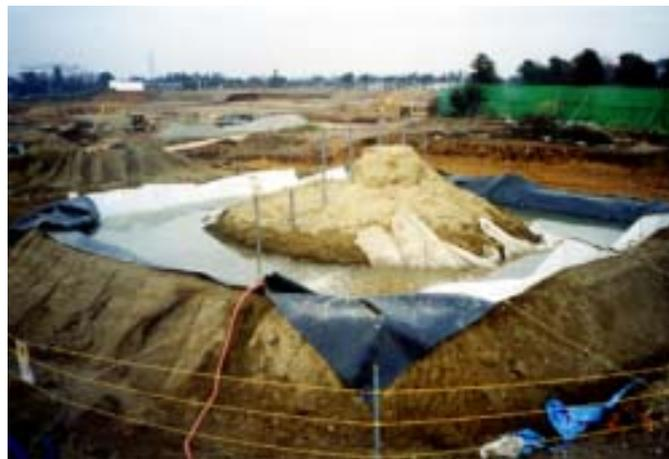
写真 - 2 人工トレーサ溶液の水張り試験状況
