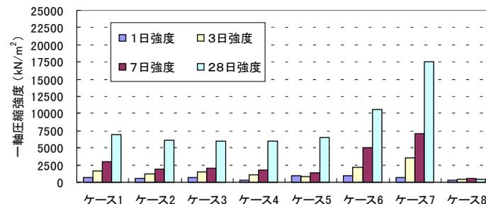
図-4 割裂試験より算出した一軸圧縮強度
