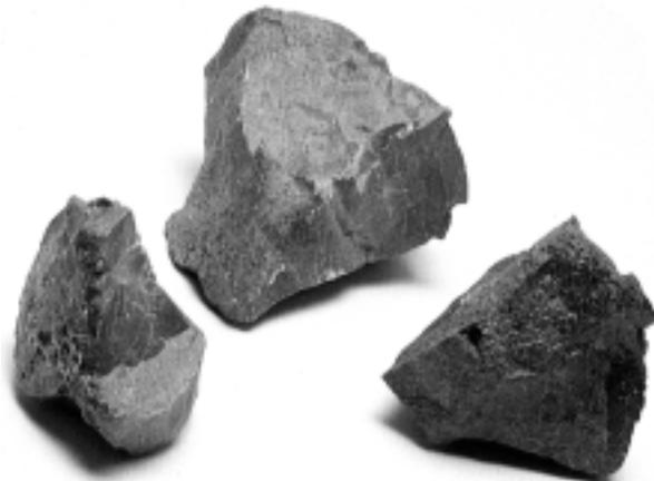
写真 - 1 徐冷スラグ粗骨材の形状
