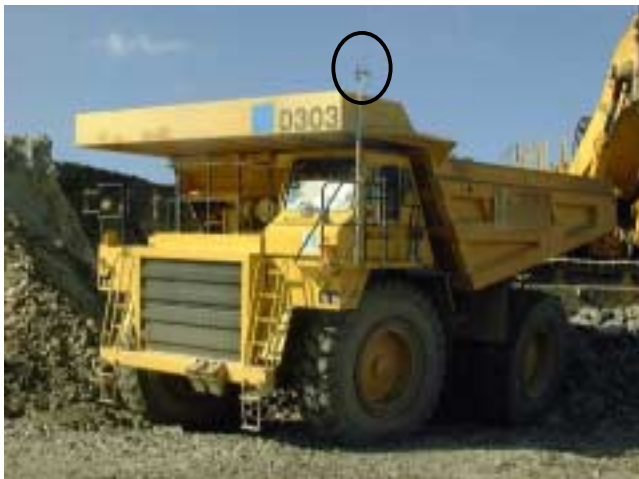
写真 - 1 重機に設置した SS 無線機と GPS 受信機
