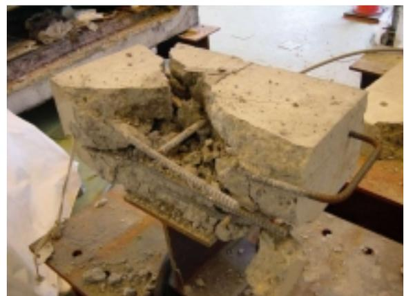
写真3 RC床版部分試験体の破砕状況
