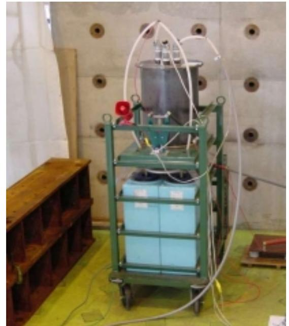
写真1 コンクリート破砕装置電源部
