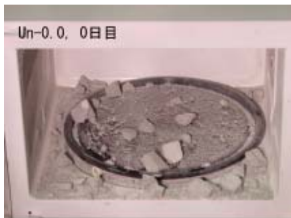
写真 - 1 モルタルの破壊状況
