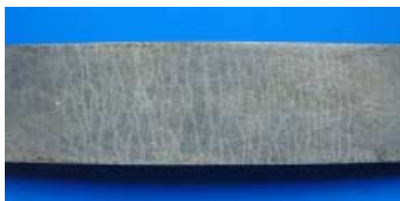
図 - 1 マイクロクラッキング（曲げ破壊後）
