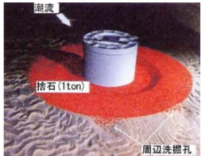
図 - 3 水理模型実験による周辺洗掘
